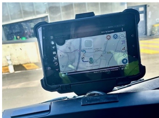
Système de géo-guidage dans les bennes de collecte
