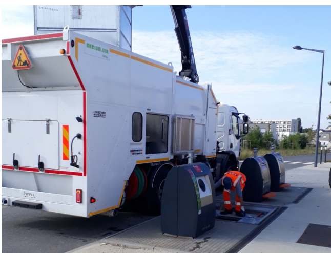
Lavage intérieur / extérieur des conteneurs enterrés
