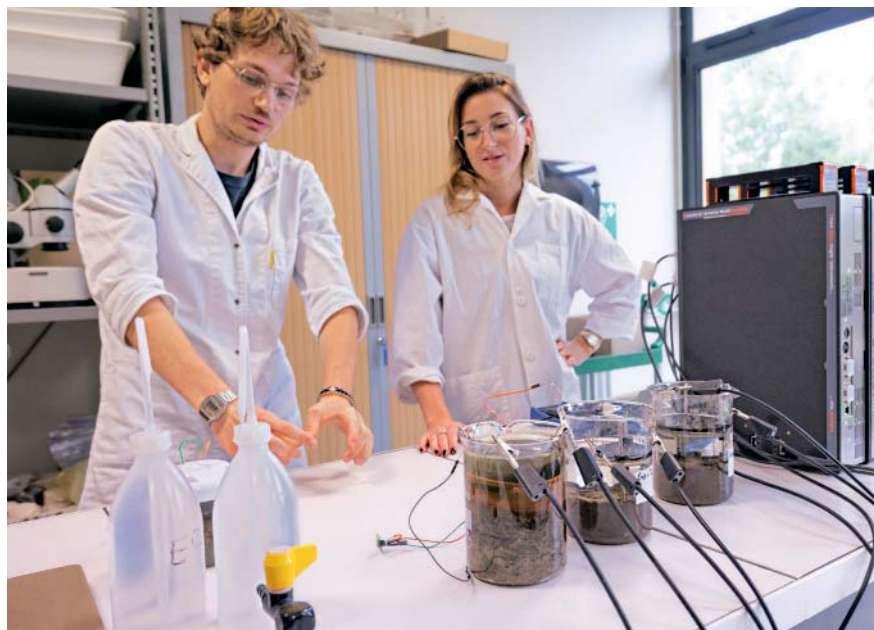
Alexandre Le Thuaut, élève à l'Esaip, et la doctorante Ilona Marmouget-Joyau analysent l'activité des biopiles branchées aux échantillons d'eau et de sédiment.
