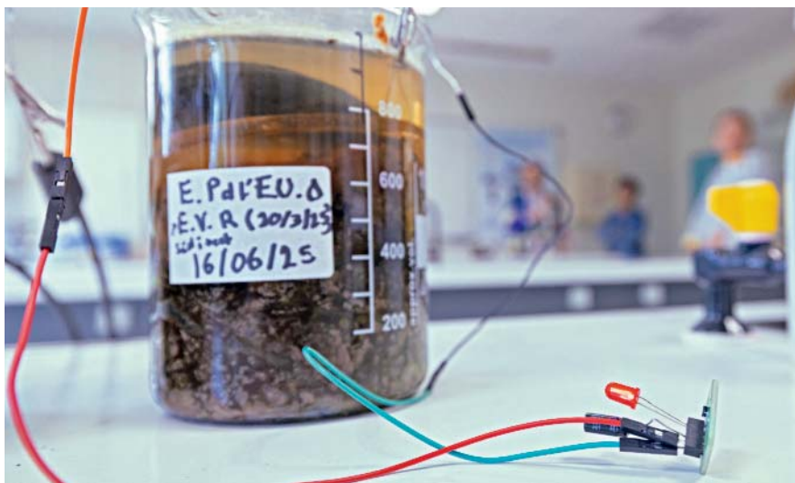
L'électricité produite par l'activité des micro-organismes dans le sédiment allume la diode.
