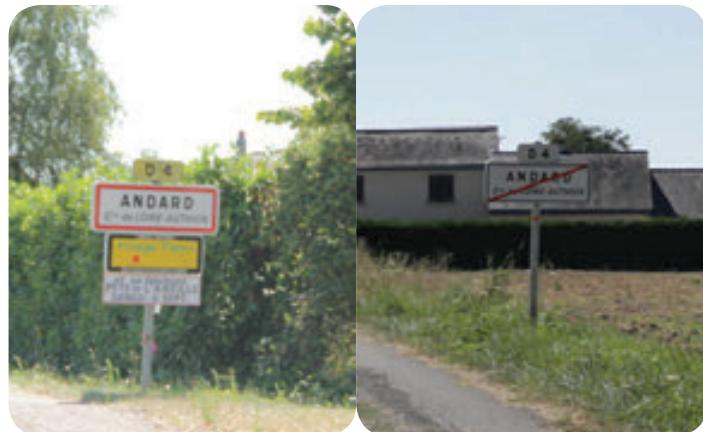
Ces panneaux font l'objet d'une implantation conformément à un arrêté municipal (Art. R.411-2 du code de la route). Les panneaux d'entrée et de sortie sont quelquefois mal implantés : ils se trouvent parfois trop en amont ou en aval des zones bâties, d'autres fois la zone bâtie s'est progressivement étendue sans que les panneaux n'aient été déplacés. Il peut également arriver qu'ils n'existent pas.
