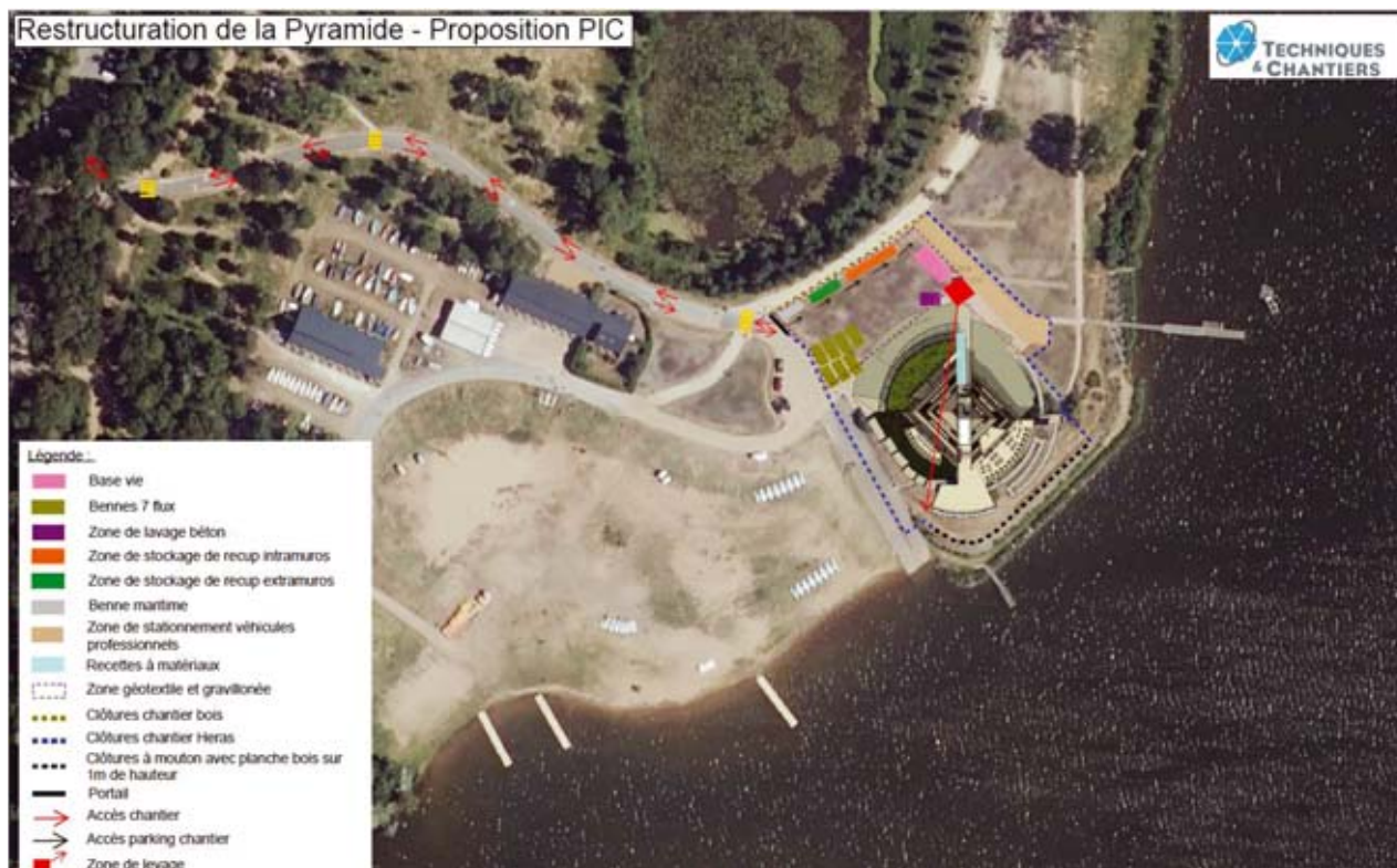
Figure 119 : Proposition de plan d'installation de chantier
