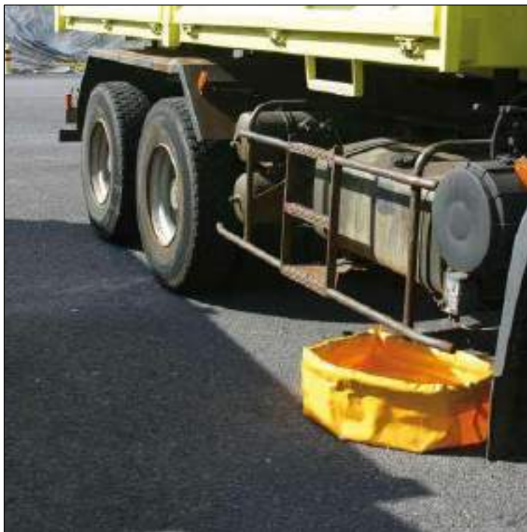
Figure 45 – Exemple de bac de rétention souple pour les véhicules de chantier
