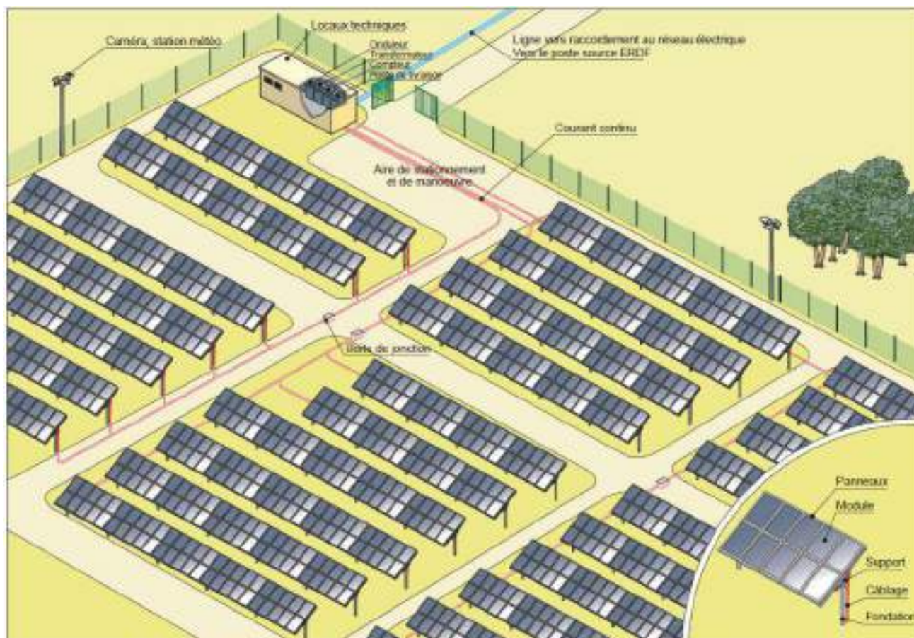
Figure 4 : Schéma de principe d'une installation photovoltaïque
