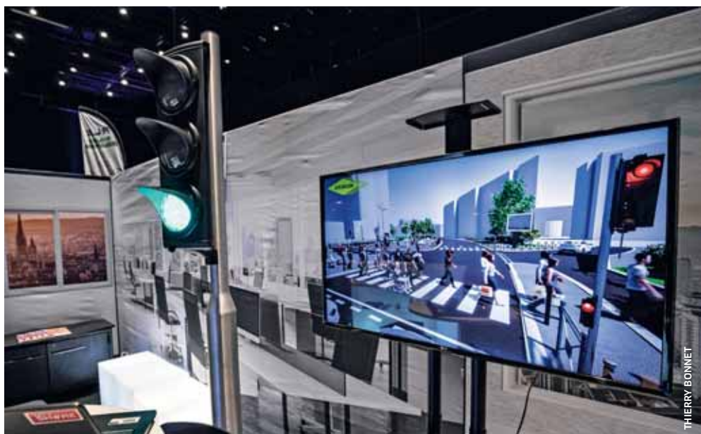
Innovation mondiale dans le domaine de la voirie intelligente, le passage piéton lumineux par détection (ici visible sur l'écran) pour assurer la sécurité des personnes qui traversent.
