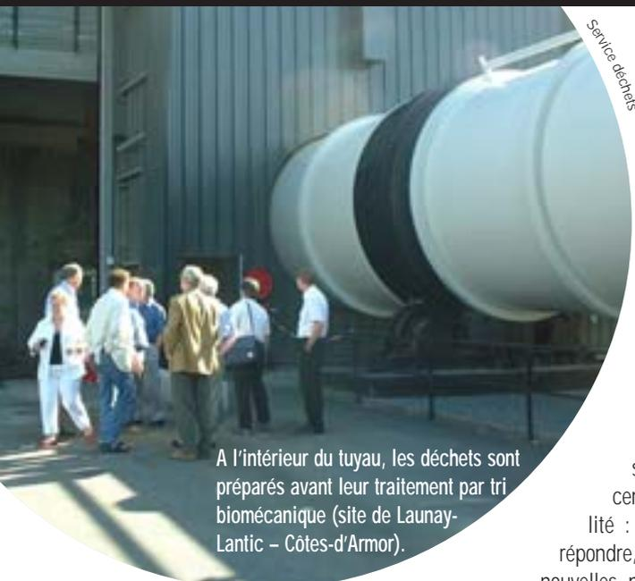
A l'intérieur du tuyau, les déchets sont préparés avant leur traitement par tri biomécanique (site de Launay-Lantic - Côtes-d'Armor).
