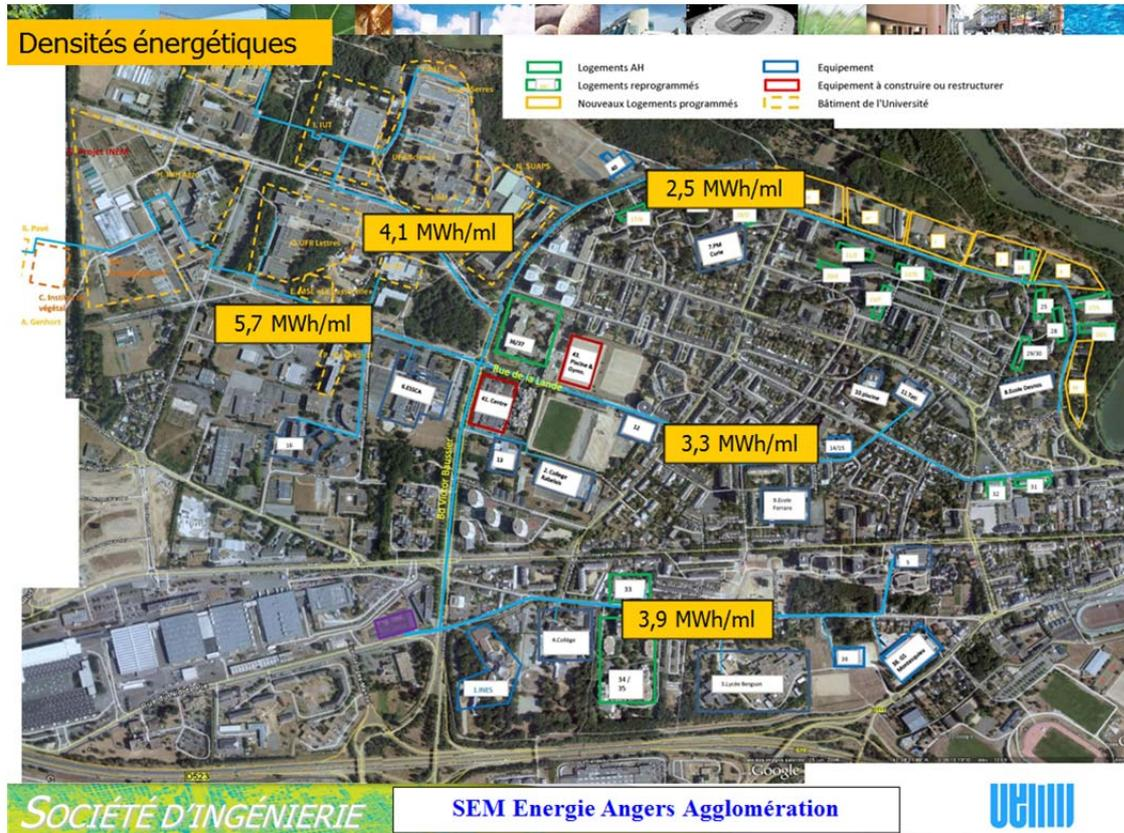
Figure 6 – Aperçu des densités énergétiques du futur réseau (Source étude de faisabilité pour la création d'un réseau de chaleur et d'une chaufferie Biomasse sur le quartier de Belle Beille à Angers)
