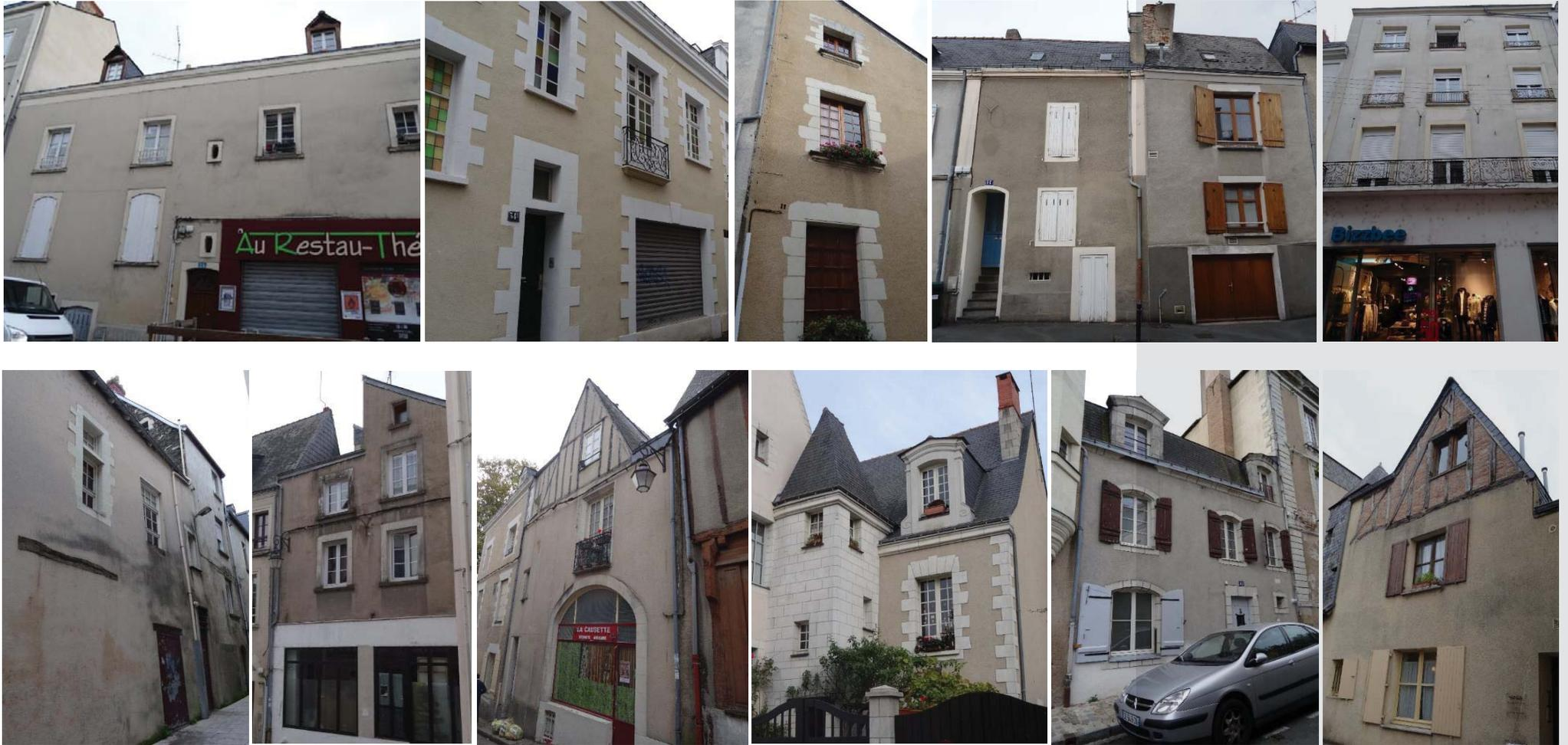
Exemples de restauration posant des problèmes de simplification de l'architecture, d'enduits inadaptés, ou encore de reprise de l'architecture (encadrements de baies, lucarnes) sans égard à la typologie de l'édifice.
